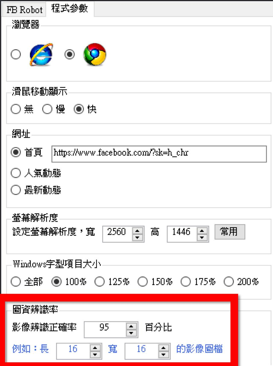
您也可以將影像辨識正確率調整為 95%，可解決因瀏覽器重開時渲染造成圖資些微差異現象。
